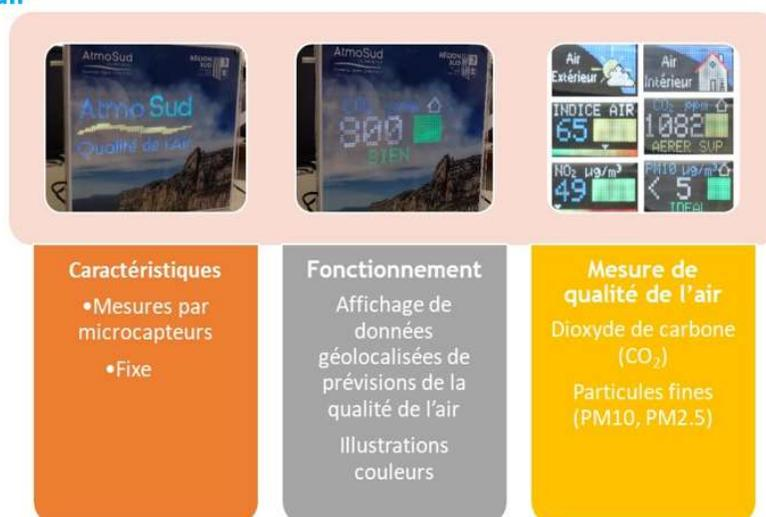
Figure 23 : Module Air, dispositif de mesures communicant, AtmoSud
